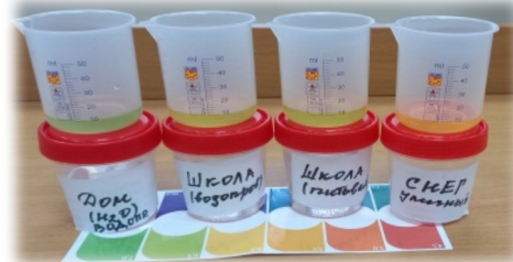
Определение pH воды жидким индикатором
