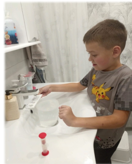
Измерение струемером диаметра струи воды
