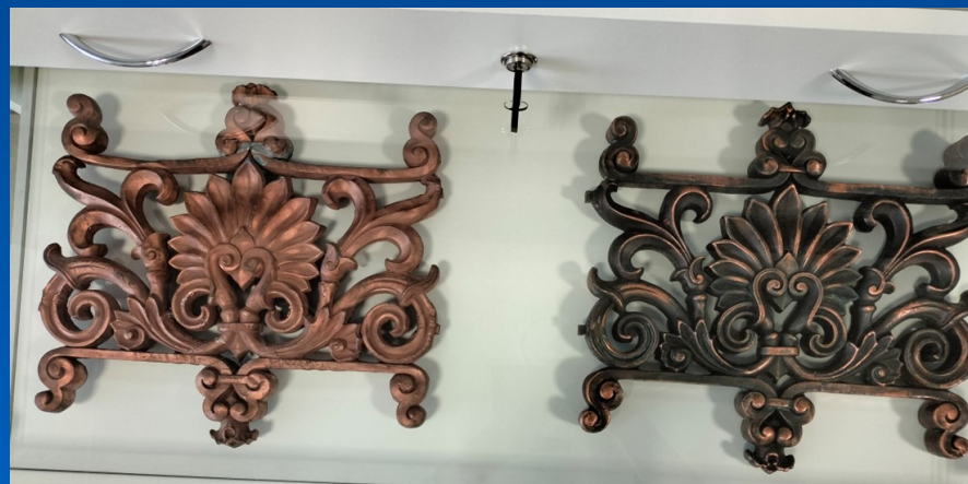
Фрагмент лестничной балюстрады, выполненный методом гальванопластики.
